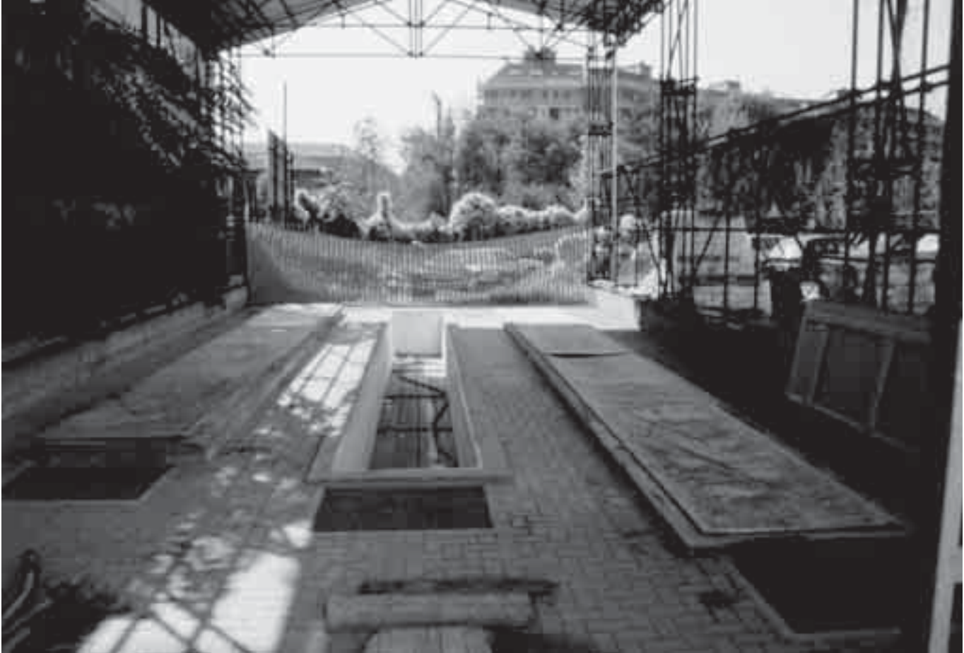
325 - Milano, Centro Trattamento Legno Bagnato. Le vasche di trattamento.
