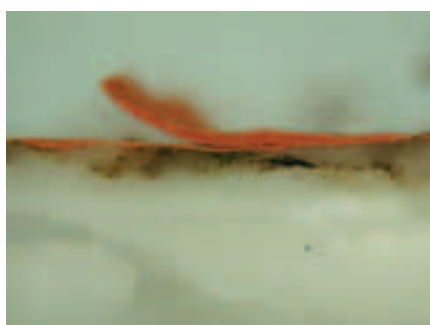
Fig.6: Pellicola pittorica rossa a base di resine acriliche, talco ed ossidi di ferro.
